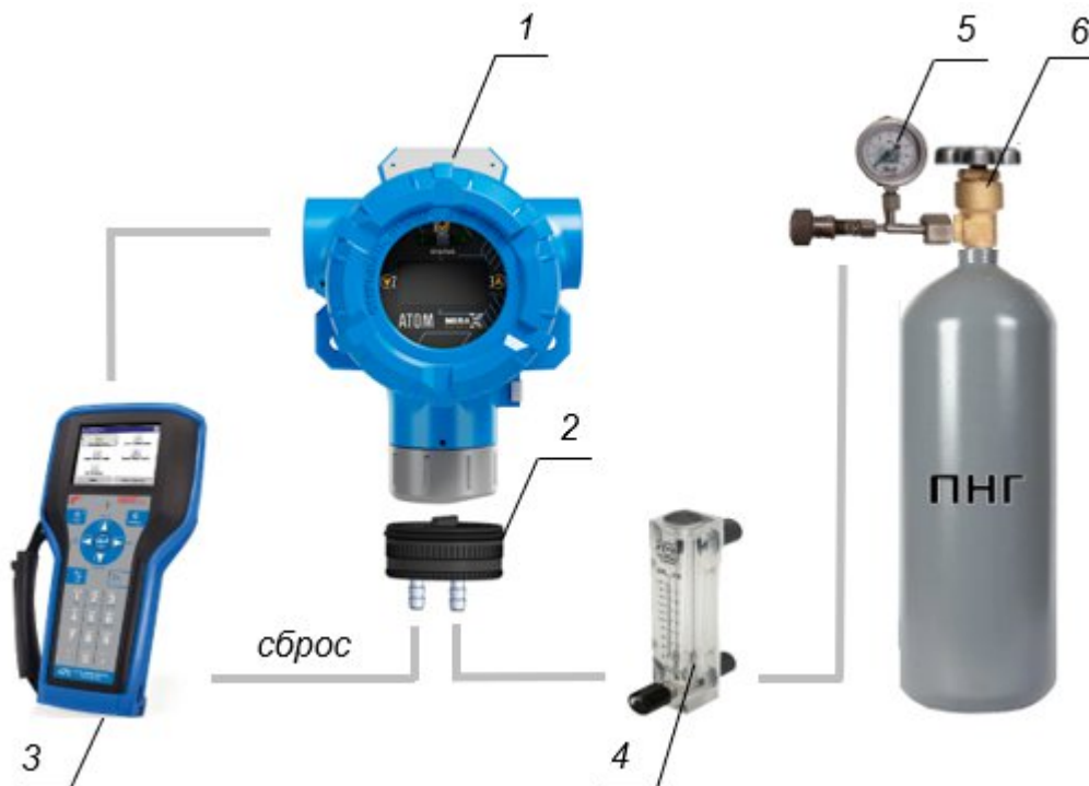
Рисунок 41 – Комплект для калибровки нуля при помощи HART-коммуникатора 1 – АТОМ; 2 - калибровочная насадка; 3 - HART-коммуникатор; 4 – ротаметр; 5 – натекатель; 6 - ПНГ (поверочный нулевой газ) либо заведомо чистая атмосфера без остаточного количества определяемого газа
