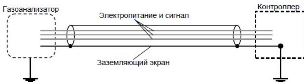
Рисунок 24 – Заземление экранированного кабеля
